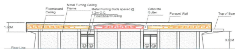
SECTION THRU 'B-B' Scale: 1:225M
